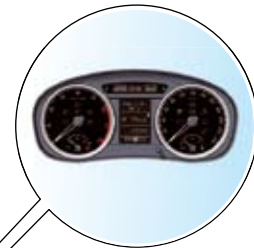
Steuergerät im Schalttafeleinsatz J285
